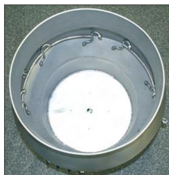
Reinigungsfass mit Sprühdüsen in unterschiedlichen Anordnungen
