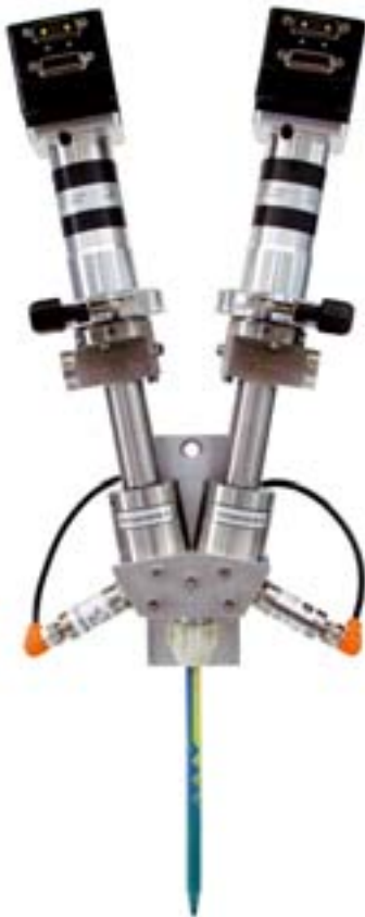
Der ventillose 2K-Dispenser vermischt und dosiert die beiden Klebstoffkomponenten
