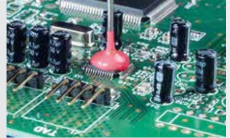
» 2 Verguss von Elektronikbauteilen – das System der Wahl, wenn man nicht mehr an die Bauteile muss
