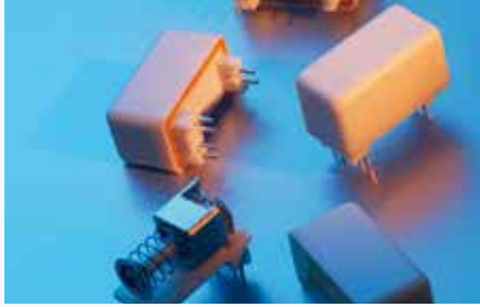
»4 Elektronische Komponenten – wie diese Airbag-Sensoren – stellen hohe Anforderungen an die abdichtende Klebtechnik
