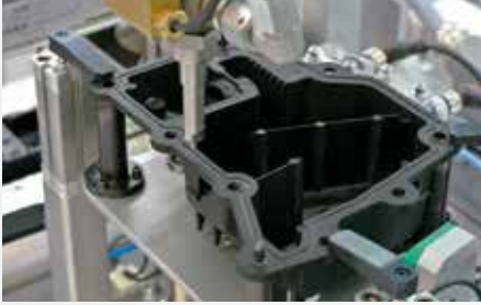
»3 Abdichtung einer Ölwanne mit Silikon
