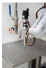
Konzept zur dynamischen Steuerung von Raupenquerschnitten auf Basis einer integrierten, zusätzlichen Roboterachse
