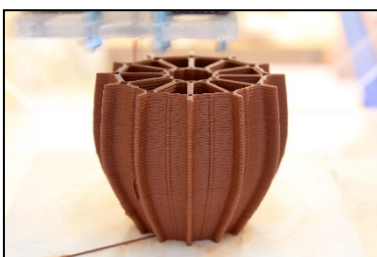
Druckprozess bei Unfold mit dem FDD-Verfahren von ViscoTec.
