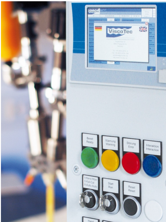
Bild 4: Bei dieser speziell entwickelten 2K-Dosiersteuerung lassen sich mit Hilfe der eingebundenen Rezeptverwaltung unterschiedliche Mischungsverhältnisse und somit Produkteigenschaften voreinstellen, hinterlegen und mit wenigen Klicks über das Touchpanel aufrufen.
