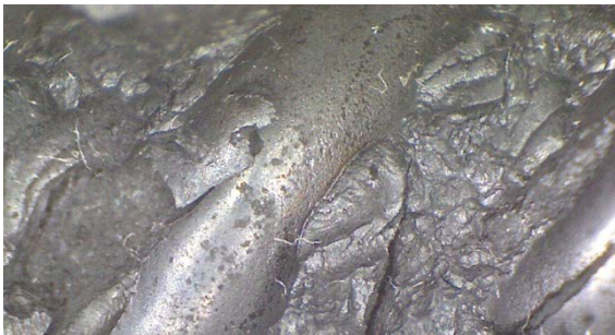
Abb. 2: Tribochemische Reaktion eines Elastomers
