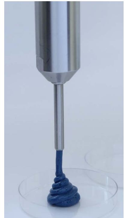
Abbildung 3: Viskositätsunabhängige Dosierungen mit dem ViscoTec Pharma Dispenser
