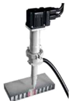
Заполнение клеем низкой плотности, например, эпоксидным клеем – **Заполнение сотовых структур**
