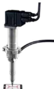
Герметизация методом Glob Top однокомпонентной заливочной массой, например, УФ эпоксидной смолой – **Заливка печатных плат**
