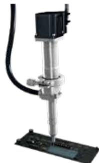
Подкристальная заливка однокомпонентным клеем, например, клеем двойного отверждения – **Заполнение полостей**
