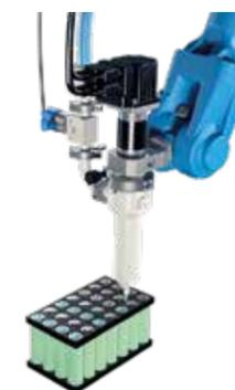
Заливка теплопроводным клеем, например, полиуретаном – Заливка элементов управления
