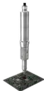
Нанесение защитного лака, например, акрилата – Нанесение покрытия на печатные платы
