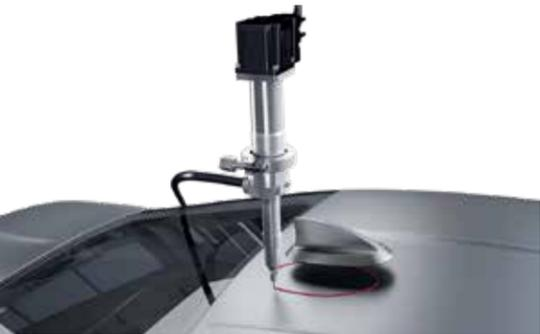
Непрерывное нанесение однокомпонентного герметика, например, силикона – Герметизация фар
