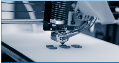
Fused Filament Fabrication bei der Produktion.
